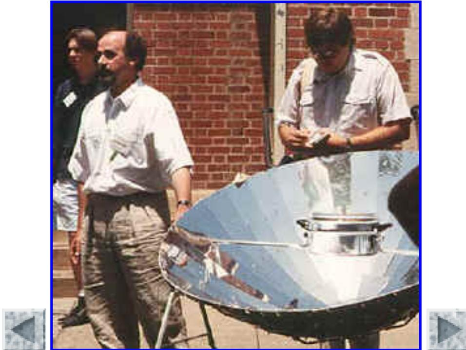
Las cocinas parabólicas enfocan la luz del sol en la parte inferior de un solo caldero. Alcanza temperaturas muy altas, pero necesitan ser reenfocadas regularmente para que sigan el sol. Los últimos modelos que se han fabricado como el de la foto incluyen algunas mejoras para reducir los accidentes como ahora quemaduras en la piel o la vista.
