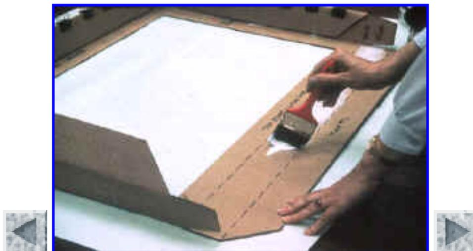
La tapa se construye a partir de otra pieza de cartón. Una lámina de cristal o film de plástico puede utilizarse para tapar la abertura.
