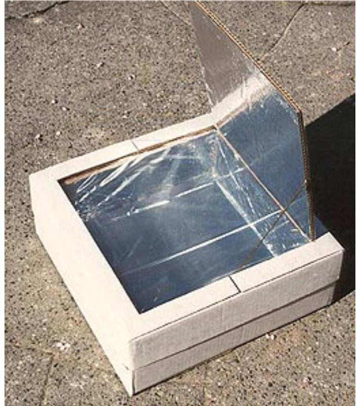
2. Pliega un trozo de cartón extra para que haga de revestimiento del interior de la parte de la base.
