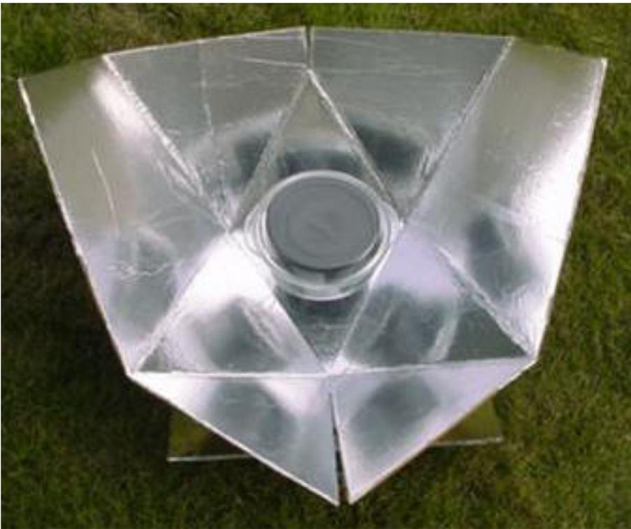
Para cocinar, primero colocamos la DSPC según la altitud del sol, la encaramos al sol. Metemos los alimentos en un recipiente de metal negro, y a su vez, metemos éste en una bolsa para horneado o en un recipiente de cristal con tapa. Colocamos el recipiente en medio de la base de la DSPC, elevándola un poco (5 cm,
