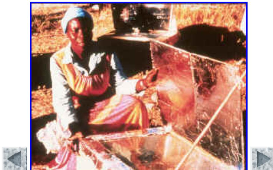
Entonces pegamos un reflector de cartón a una de las caras de la tapa. Éste hace rebotar mayor cantidad de luz a la cámara de cocción. Las cocinas de este tipo sólo necesitan ser giradas para seguir el sol cada 3 ó 4 horas. De todos modos, muchas veces no hace falta girarla para nada.
