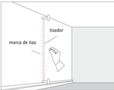
Luego se pone un clavo en la marca de abajo, se saca el plomo y se amarra una lienza con tiza (ver tizador) a ambos clavos. Se tenza, y luego se tira y se suelta la lienza para que la tiza marque la vertical.
