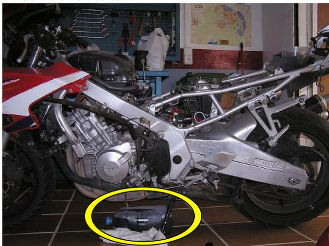
Localiza el tornillo de vaciado del cárter (suele estar debajo, si estuviese encima no vaciaría). Coloca el recipiente para recoger aceite debajo del tornillo y desenróscalo, cuidado NO te quemes, ya que esta operación debes efectuarla como una media hora después de haber encendido la moto para que el aceite este mas licuoso. Verás que el tornillo esta provisto de un pequeño imán, es para atraer elementos metálicos sueltos por tu motor, límpialo.
