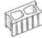
Figura 10. Superficie moldeada ranurada, 5 ranuras
