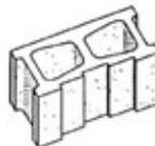
Figura 142. Superficie moldeada escalonada
