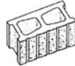
Figura 22. Superficie moldeada ranurada y partida, 5 ranuras
