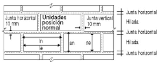
Figura 132 - Dimensiones aplicadas al muro
