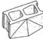
Figura 143. Superficie moldeada angulada
