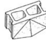
Figura 6. Superficie moldeada angulada
