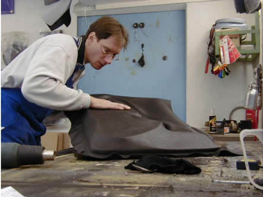
Sujete todo bien y asegure que no se va a despegar. Puede empezar la fase final y enmoquetarla, como se ve bien en la foto. Sujete un lado del vinilo con grapas. Va pegando con pegamento
