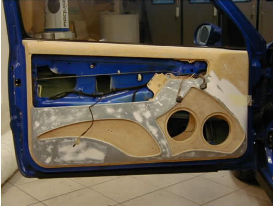
Una vez la pieza esté bien seca, la lija y enmasilla si hiciera falta (como en la foto) hasta que vea que no tiene arrugas ni bultos y queda bien acoplada a todas las formas de la puerta original.
