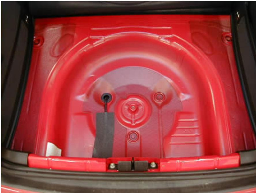
Impria bien todo de resina y después con planchas de matt forre todo el hoyo de la rueda de repuesto hasta notar que tiene un espesor lo suficientemente duro como para resistir las vibraciones.
