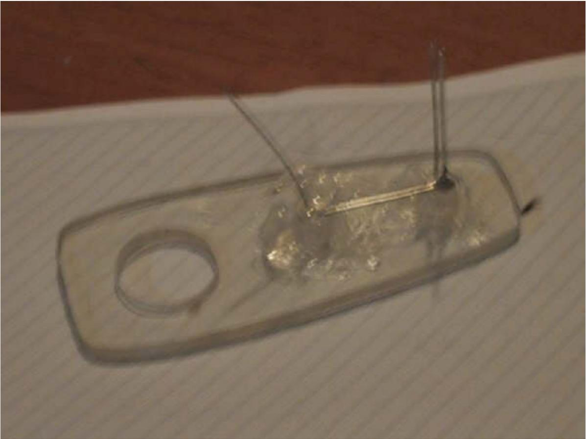
Corta el trozo de pata sobrante, conecta el cable a las patas de alimentación/masa y añade más silicona
