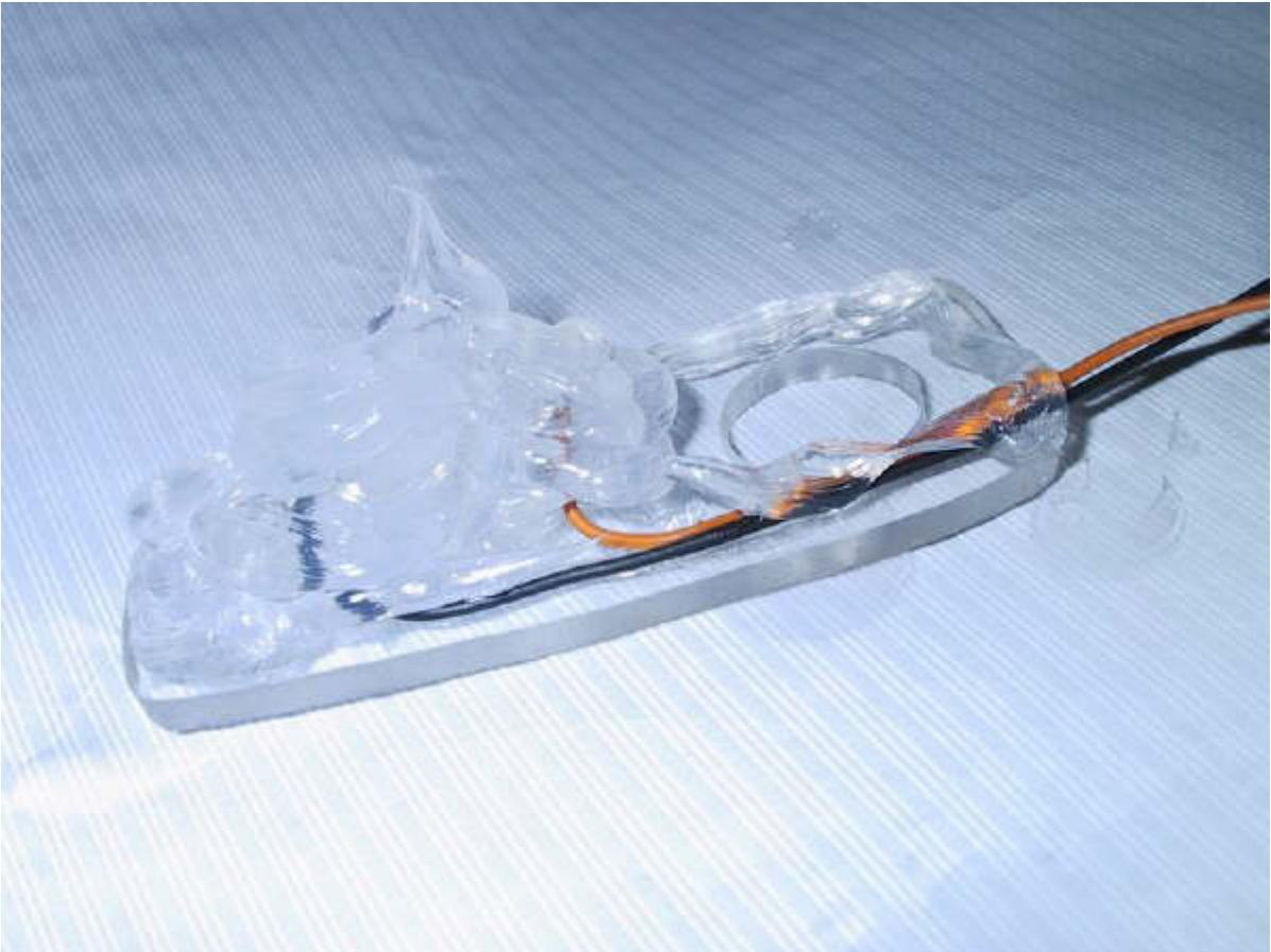
Finalmente, interpone una resistencia que sea mínimo de 330 ohmios para abajo (según el brillo y la vida que desee para los leds), lo conecta, y debería quedar como en las siguientes fotos (resultado final, apagado y encendido).
