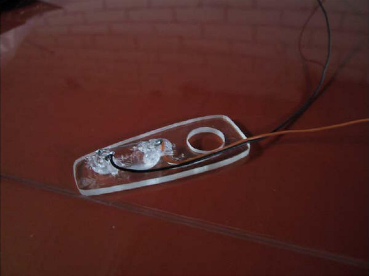
Coloca un poco de silicona para asegurarse de la firmeza del conjunto, y coloca encima el cubrechorros.
