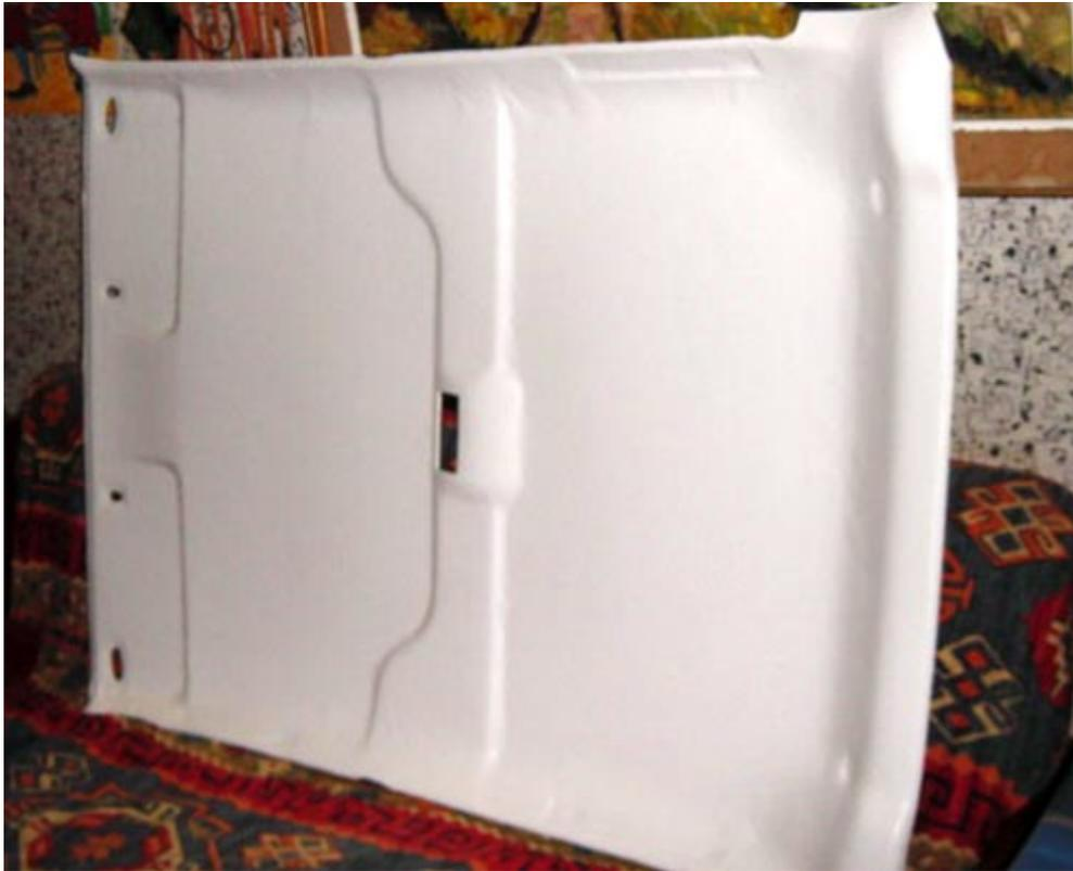
Ahora, agarre el destornillador punzón o algo punzante (se recomienda punzón ya que agujerea pero no hace corte. Y realice una puntada donde tienen que ir los tornillos. Realice una nueva puntada por la parte de la tela para no despegarla, sujete con el dedo y va retirándolo poco a poco para no despegar.
