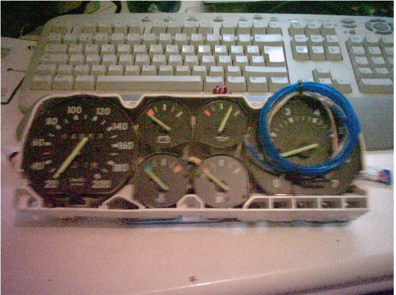
3º Con una lima (en este caso se ha utilizado un minitrompo con una minirotaflex) para abrir los hoyos por donde pasará el neón; pero previamente tiene que colocar el neón por encima de los relojes para calcular donde debe hacer las ranuras y como colocarlo para que no falte hilo.
