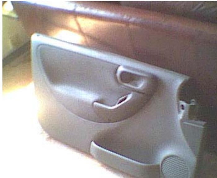
2- Muestra del neón. Para poderlo poner tiene que cortar un poco de la espuma que lleva la puerta.
