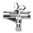
Son en general mas caros, pero sin duda muchísimo mas versátiles que los anteriores debido a que se tiene el control absoluto de la cantidad de aire y pintura que sale del aerógrafo. Accionando hacia abajo la palanca controlamos el aire y tirando hacia atrás, el caudal de pintura. Esta diferencia hace de este tipo de aparatos que estén en lo mas alto del listón de los aerógrafos profesionales.
